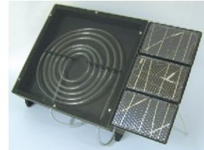
Μια κατασκευή με πολύ καλή λειτουργία. Είναι μία μηχανή που χρησιμοποιεί την ηλιακή ακτινοβολία για να ζεστάνει νερό.
