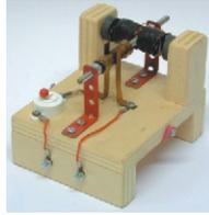
Απλή κατασκευή. Χρησιμοποιεί δύο μόνιμους σταθερούς μαγνήτες κι έναν περιστρεφόμενο ηλεκτρομαγνήτη. Μπορεί να
